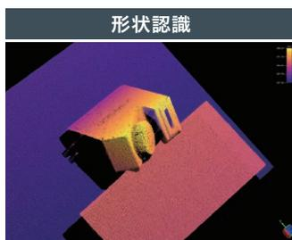
複雑な外観の製品の中から、任意の形状を認識。ASSY部品の組付け検査等に力を発揮します。
