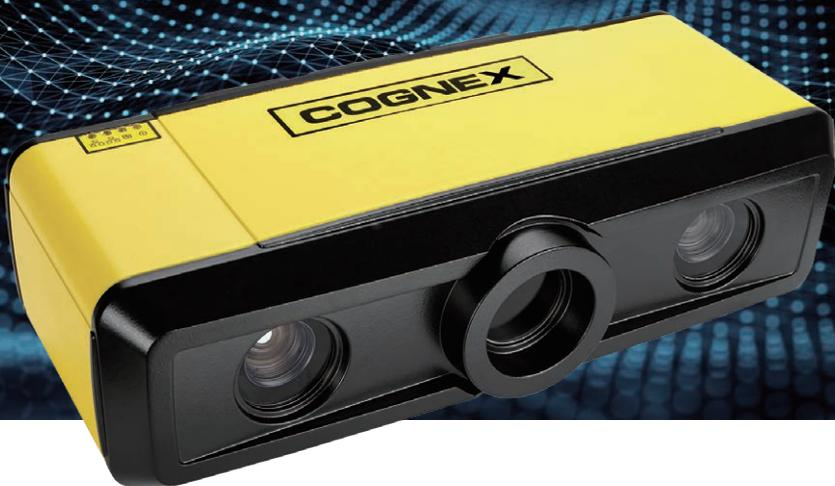
一般的な画像検査では2次元の画像データを用いるため、形状や寸法といった平面的な検査は得意でも、傷の深さや溶接痕の形状といった3次元的な判定は苦手な分野です。従来はワークを異なる角度で撮影したり照明の位置を変えたりして複数のデータを取得することで疑似的に3次元の解析を行っていましたが、スピード・コストの両面で大きな課題がありました。3D検査では、これまでの2Dカメラに代わって、3次元データを直接取り込む「3Dカメラ」を用います。従来の2次元データに「高さ情報」を加えることで、傷の深さやワークの立体的な形状、さらに容積や体積の測定も可能になります。
