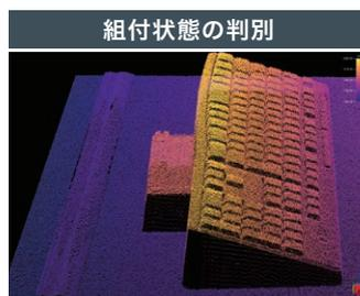
部品の有無に加え、組付け状態も同時判別。完成検査のスピードアップと精度向上を実現します。
